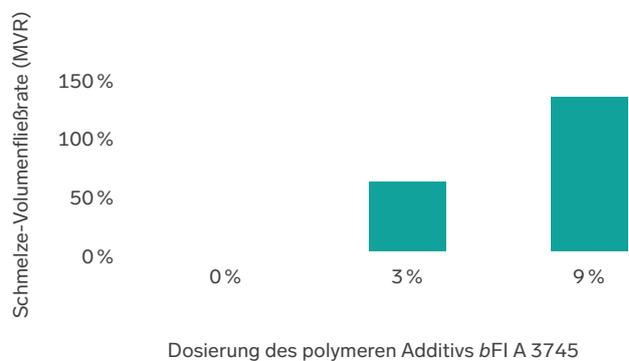
Abb. 2: Einfluss des polymeren Additivs bFI A 3745 auf thermische und mechanische Eigenschaften von PS.
