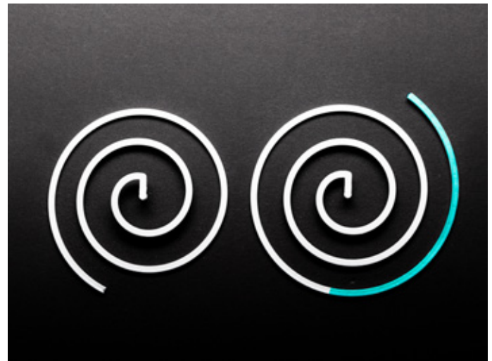
Şek. 2: Solda bFI A 3745 polimer katkısı olmadan, sağda ise katkısı olan bir akış spirali. Yalnızca %3 katkı maddesi dozajı ile 1/3'ten daha fazla genişletilmiş bir akış yolu elde edilmiştir.
