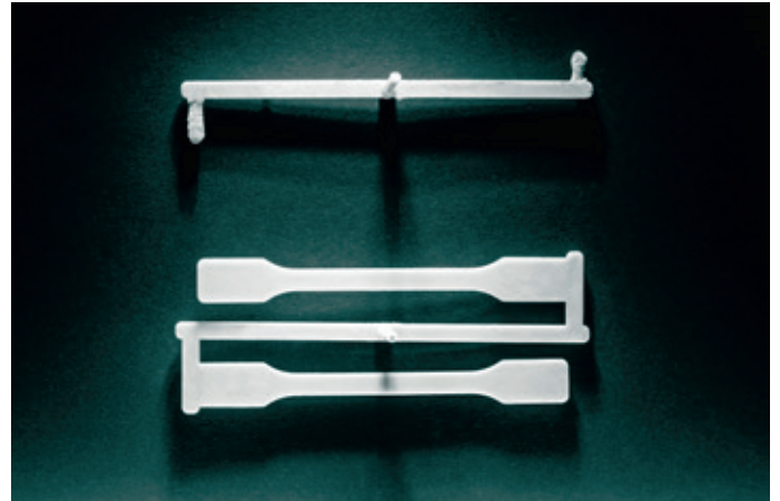
Resim 3: PHA'ların -PHBV örneğinde- aynı enjeksiyon kalıplama parametreleri (160°C, 800/700 bar enjeksiyon basıncı/takip basıncı) ile bFI A 3745 polimer katkısı olmadan (üstte) ve %7 polimer katkısı ile (altta) test numunesi dolumu.
